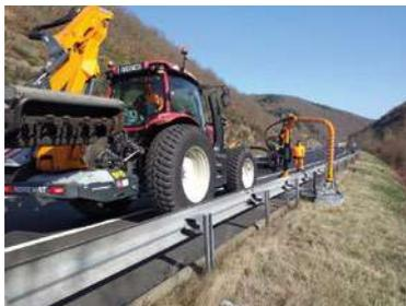
☐ Tracteur équipé d'une faucheuse sous glissière à l'avant et d'une épareuse à l'arrière
